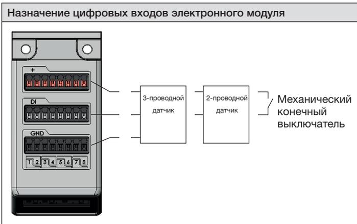
Рис. 9. Назначение цифровых входов электронного модуля
